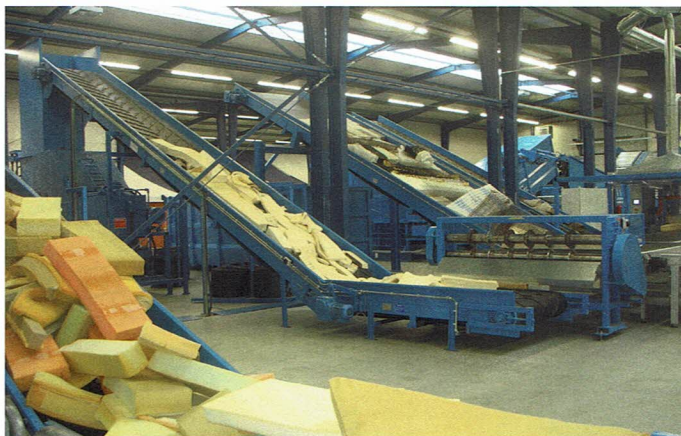
Drie van de vier afvalstromen: PU schuim, latex en metaal.
